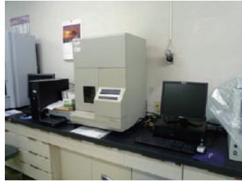
照片6 本公司开发的可以进行污染源调查的检测系统 (左: DNA测序仪, 右: MALDI-TOF/MS biotyper)
