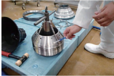
照片5 ATP荧光检测的活用事例2 检测设备拆卸后用手清洗的地方
