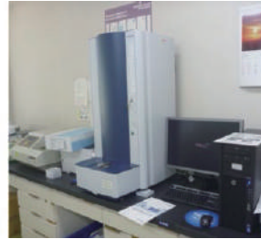
照片6 本公司开发的可以进行污染源调查的检测系统 (左: DNA测序仪, 右: MALDI-TOF/MS biotyper)
