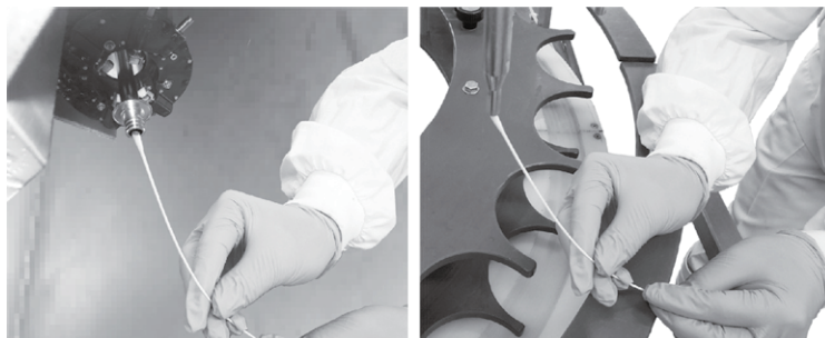
照片2 附带长轴棉棒的ATP检测试剂“LuciPac LS”的应用实例 (照片提供:龟甲万百欧凯米发株式会社,产品介绍用照片)
