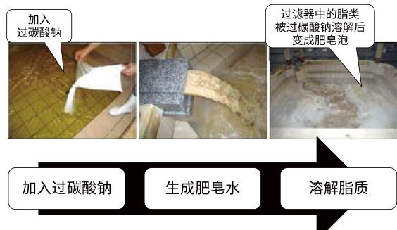
照片 6-2 PC 法的步骤：②碱性清洗
