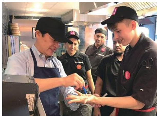
照片2 有效运用ATP荧光检测(A3法)确认洗手效果,可现场数字化结果,教育效果显著
